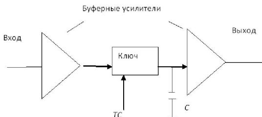
Рис. 2.54. Упрощенная структурная схема УВ/Х
