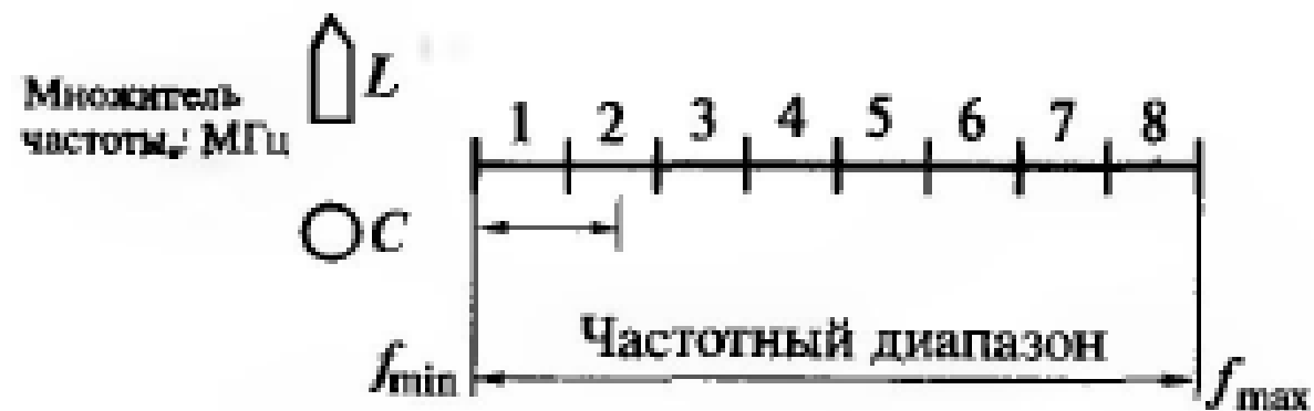
Рис. 6.2. Пояснение регулировки частоты в LC -генераторе
