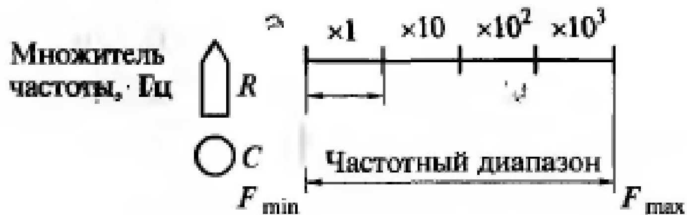
Рис. 6.1. Пояснение регулировки частоты в RC -генераторе
