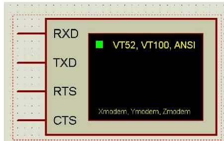
*Рис. A.33. Условное изображение терминала*
