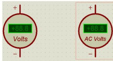
Рис. A.20. Условное изображение вольтметров переменного и постоянного (AC) токов
